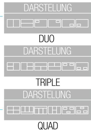
**HINWEIS** Die Darstellung / Bildaufteilung wird automatisch an die Anzahl der angeschlossenen Kameras angepasst.
