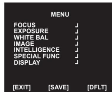
Funktionen können eingestellt werden, indem Sie „Menu Key Command“ des Visca Protokolls nutzen. Das Menü wird angezeigt und es können sieben Kamerafunktionen ausgewählt werden.
